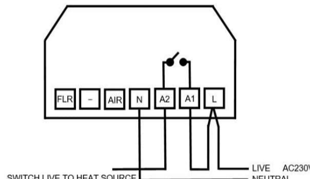
2, Безпотенциален превключващ контакт за отоплителния елемент
